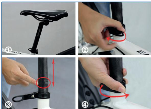
El poste del asiento tiene una línea marcando la altura máxima la cual no puede quedar expuesta. En caso de uso inapropiado, puede causar lesiones serias.
