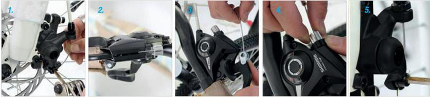
1. Aflojar el cable de freno (Fig. 1)
