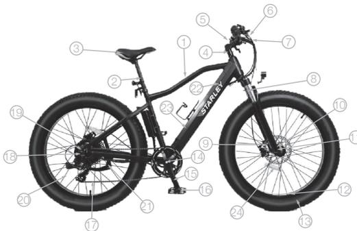
1. Cuadro de la bicicleta 2. Poste de asiento 3. Asiento 4. Potencia 5. Manubrio 6. Desviador de cambios 7. Palanca de freno 8. Horquilla delantera 9. Disco de freno 10. Placa del disco de freno 11. Eje de la rueda 12. Llanta 13. Cubierta 14. Sensor de velocidad 15. Biela de pedal 16. Pedal 17. Cadena 18. Piñón de velocidades 19. Motor 20. Radio 21. Pie de apoyo 22. Controlador 23. Batería 24. Reflector
