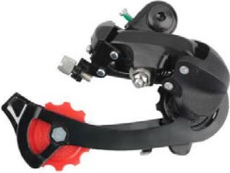
La bicicleta contiene un desviador de cambios delantero y otro trasero. Ajustar los tornillos H o L cuando los cables de cambio están demasiado flojos o tensionados, si el controlador de velocidades no funciona correctamente o se cae la cadena.
