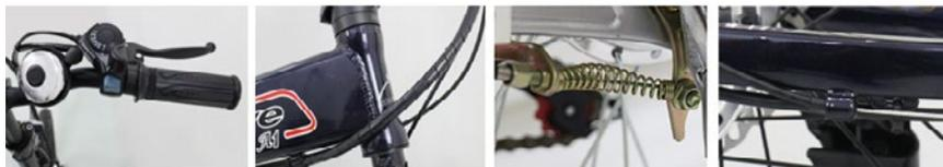
1. Palanca de freno 2. Caja de cable de freno 3. Tornillo para ajustar la tensión del resorte 4. Cable de freno
