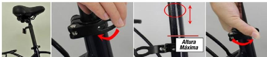
El poste del asiento tiene una línea marcando la altura máxima la cual no puede quedar expuesta. En caso de uso inapropiado, puede causar lesiones serias.
